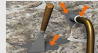
Situation après travaux: colmatage des voies d'eau
