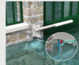
Passage possible de l'eau par les entrées de gaine
